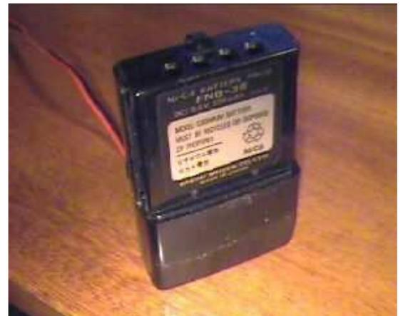
Basicamente, en la construcción de un falso pack, hay que lograr que el handy reciba tensión y corriente como si lo estuviéramos alimentando con pilas, para lo cual habrá que incorporar dentro de un pack vacío, un circuito de regulación y protección, disipadores de calor y el cable y/o ficha para alimentarlo desde una fuente de tensión externa.
