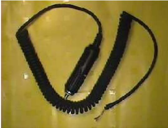
En el extremo opuesto al falso pack, el cable deberá contar con terminales, alguna ficha bipolar *polarizada*, o una ficha del tipo encendedor. Si piensa conectar el falso pack en una fuente, mantenga individualizados convenientemente los terminales, sobre todo si el regulador no cuenta con la protección de un diodo contra inversiones de polaridad.
